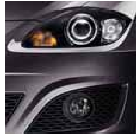
Fari allo Xenon con abbaglianti integrati, luci diurne e AFS "Adaptive frontlights System".
